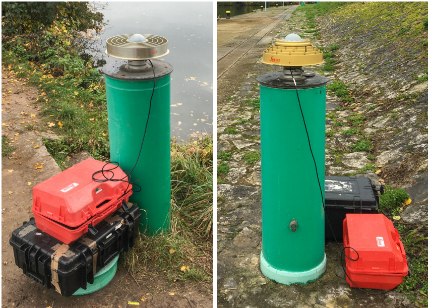
Abb. 4: Messpfiler mit den verwendeten Choke-Ring-Antennen der Typen Leica AT504GG (links) und Leica AR25 (rechts)
