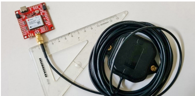
Abb. 1: Ublox ZED-F9P mit SparkFun- Board und ANN-MB An- tenne
