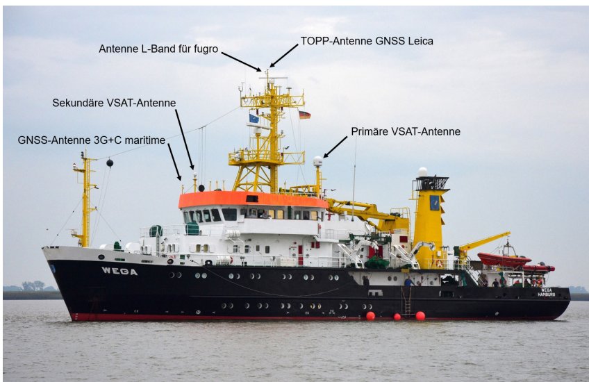
Abb. 2: VWFS WEGA des BSH mit den für die Testfahrten relevanten Antennen im September 2021
