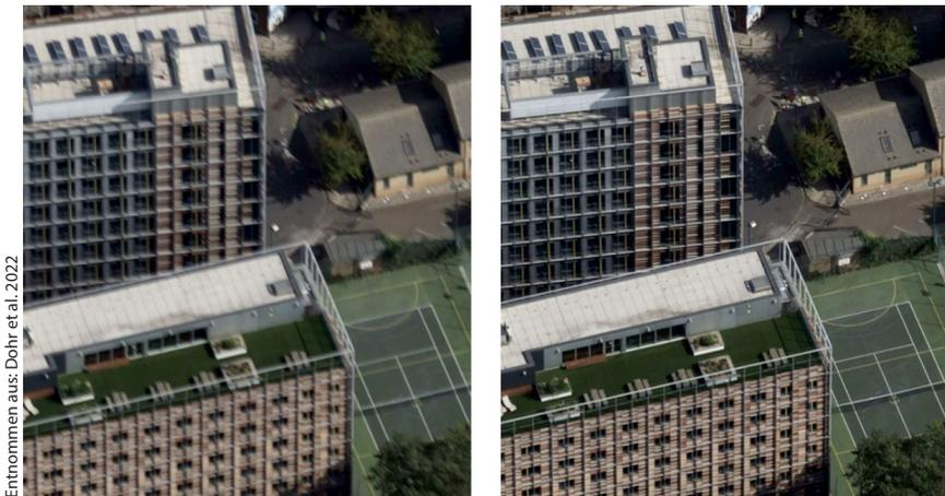
**Abb. 3:** Einfluss von AMC auf die Bildschärfe am Beispiel einer Schrägaufnahme.
