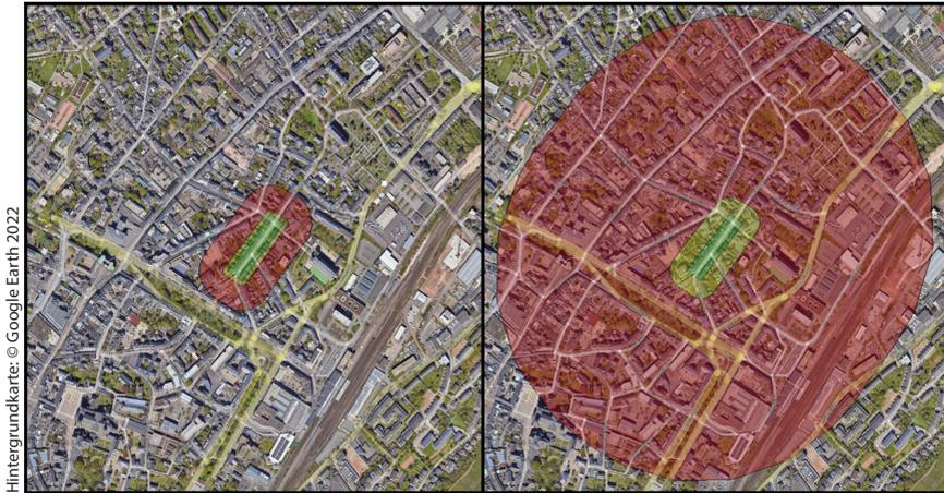
**Abb. 2:** Links: UAS-Betrieb mit Fallschirmsystem, 40 m Flughöhe, 3 m/s Fluggeschwindigkeit bei maximal 5 m/s Windgeschwindigkeit. Rechts: UAS-Betrieb mit Fallschirmsystem, 110 m Flughöhe, 15 m/s Fluggeschwindigkeit bei maximal 15 m/s Windgeschwindigkeit. Grün: Flight Geography; gelb: Contingency Volume; rot: Ground Risk Buffer
