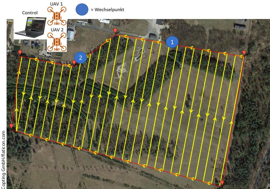
Abb. 10: Dynamischer Wechsel UAS
