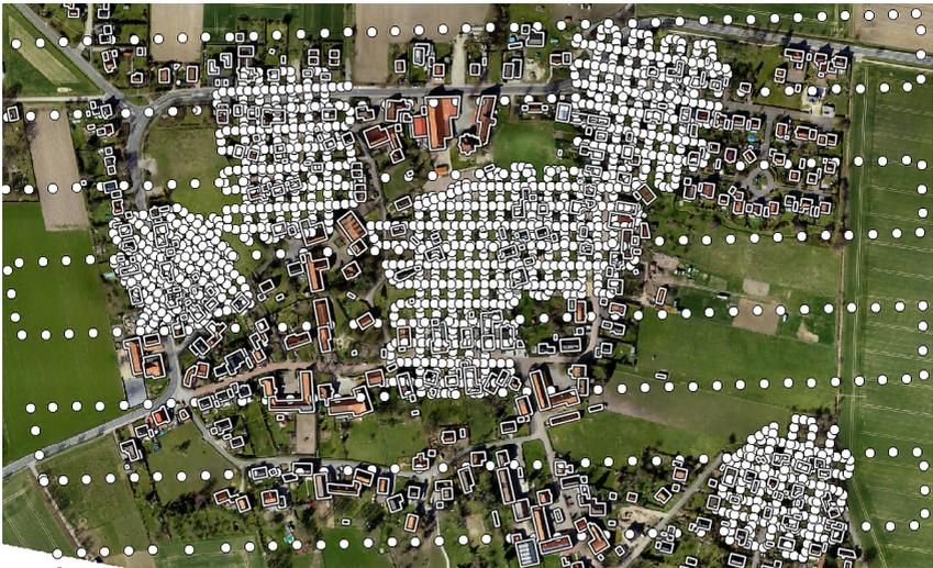
**Abb. 1:** Aufsicht der Befliegung in Wassel zur gezielten Erfassung von UAV-Bildern (weiße Punkte) zur Gebäudeeinmessung und einem Übersichtsflug. Das daraus berechnete Orthophoto mit überlagerten Gebäudeumringen aus dem Amtlichen Liegenschaftskatasterinformationssystem (ALKIS) ist hinterlegt.
