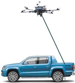
**Abb. 7:** Gefesselte Drohne auf Fahrzeug
