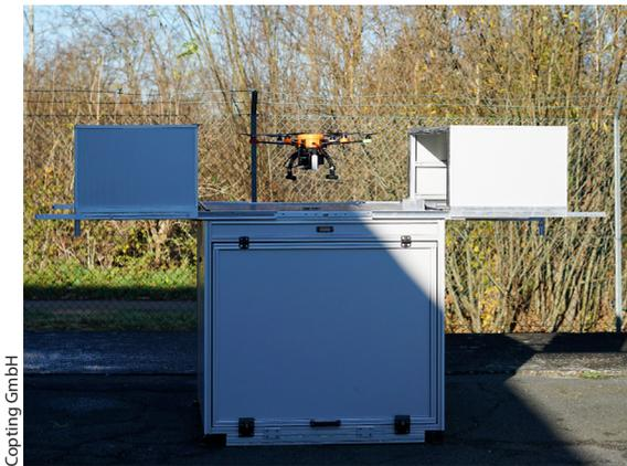
Abb. 5: Hangar-basierte Flugsysteme
