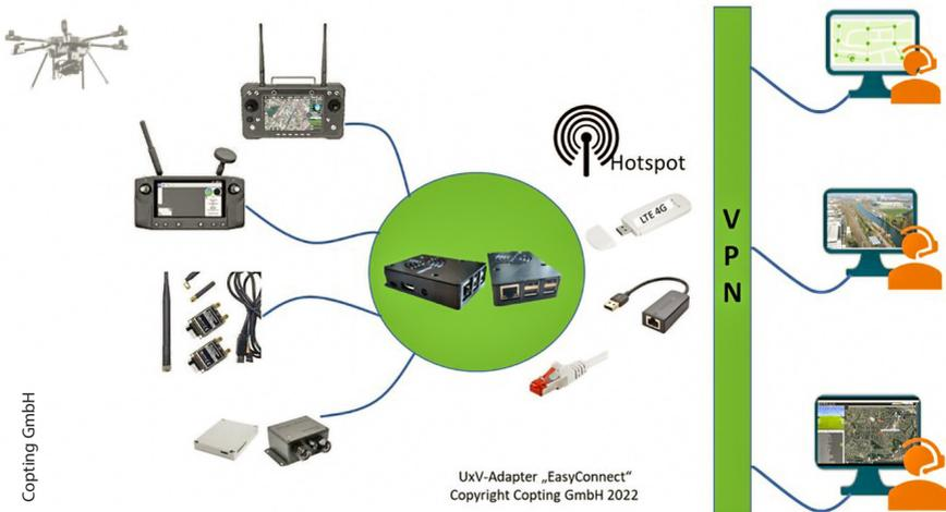
Abb. 3: Schema einer zentralen Steuerung dezentraler UAS (Copting GmbH)
